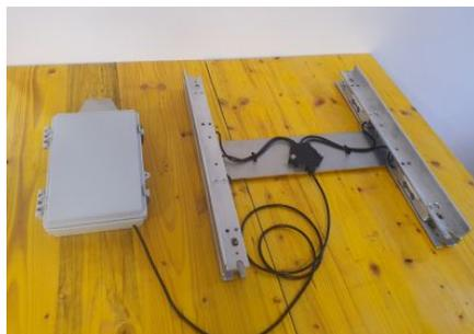
**Attention, les connecteurs doivent être parfaitement propres et secs. Il faut les serrer délicatement, mais fermement. Après plusieurs mois, resserrez les connecteurs qui se desserrent avec les variations de température.**
